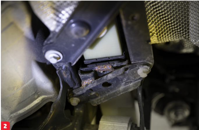
2. Delar av bakaxelns hjälpram och infästningspunkten för kompositbladfjädrarna har blivit rostangripen. Svetsfogarna har tunn lack och sitter utsatt. Notera att rosten gärna vandrar runt skarpa vreck, det är där lacken är som tunnast.
