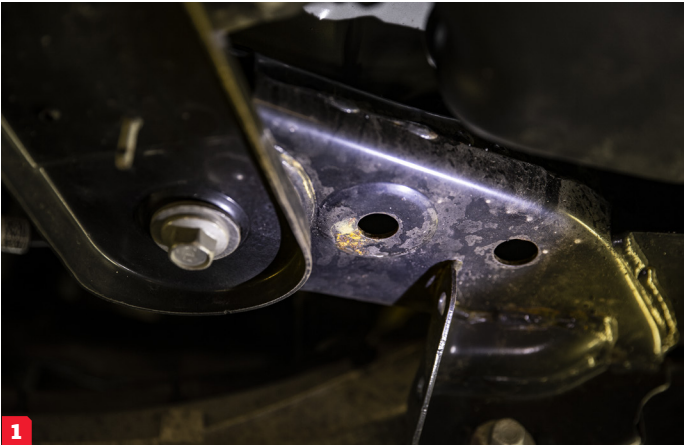
1. Rost har börjat etablera sig runt bakaxlens hjälpram. Notera att lackeringen bitvis har nöts bort, inom en inte avlägsen framtid riskerar rostangreppet att bli besvärande omfattande.
