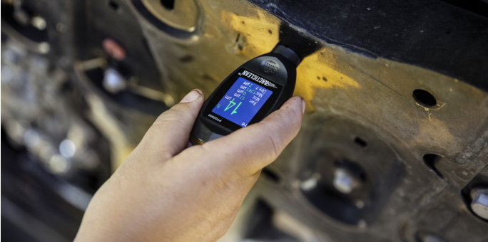
Med hjälp av en my-mätare kontrollerar Thomas Widström lackens och förzinkningens tjocklek ända ned till den rena plåten. 14 my är tunt. En fabrikslackad bilplåt, och då pratar vi om regnskyddet, har normalt en tjocklek på 105–130 my.
