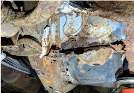
Den Mazda 6 som kördes i frontalkrockprovet hade kraftiga angrepp undertill. Tvärbalken bakom vänster framhjul var nästan helt bortrostad.
