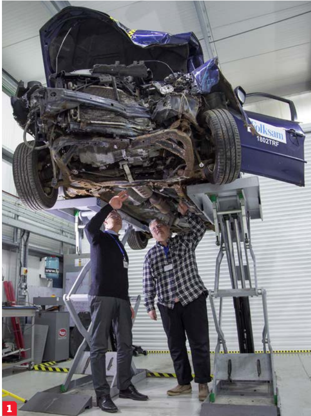
1. Anders Kullgren på Folksam och Vi Bilägares rostskyddsexpert Thomas Widström granskar vraket efter frontalkrocken. 2. Den inre sidobalken på vänster sida har fått sig en rejäl törn. Balken har bockats på fyra ställen, markerat med kryss på bilden, och som en följd har golvet höjts med ungefär 15 cm. 3. Det tillknycklade golvet fick förarstolen att tippa framåt och mot dörrstolpen, vilket i sin tur påverkade krockdockans rörelse (se faktarutan här nedanför).
