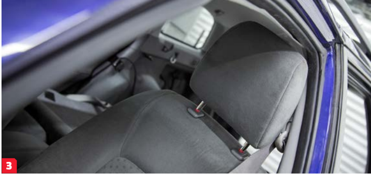
1. Anders Kullgren på Folksam och Vi Bilägares rostskyddsexpert Thomas Widström granskar vraket efter frontalkrocken. 2. Den inre sidobalken på vänster sida har fått sig en rejäl törn. Balken har bockats på fyra ställen, markerat med kryss på bilden, och som en följd har golvet höjts med ungefär 15 cm. 3. Det tillknycklade golvet fick förarstolen att tippa framåt och mot dörrstolpen, vilket i sin tur påverkade krockdockans rörelse (se faktarutan här nedanför).
